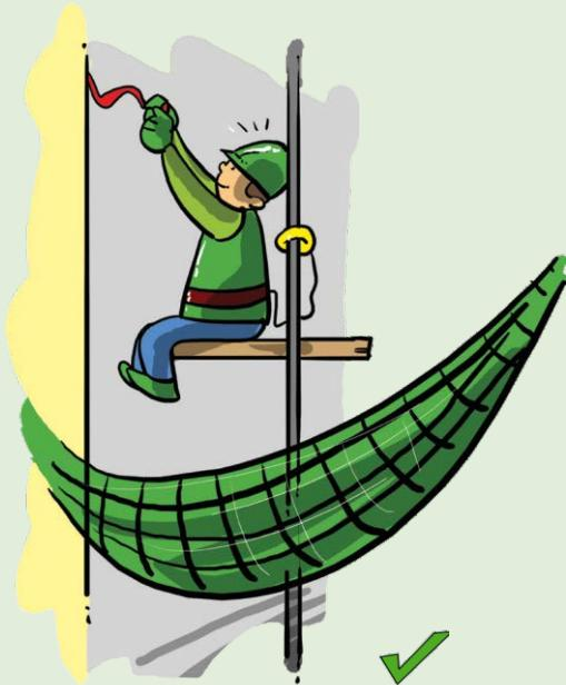
U svim radnim zonama gdje postoji rizik od pada, mora postojati zaštita na 360°. To se postiže kroz dvostruke zaštitne rampe, prečage za sprečavanje klizanja i obezbjeđivanje minimalnog razmaka između radnih platformi i bilo kakvog objekta. Sigurnosne mreže i opasači također mogu pojačati bezbjednost. Međutim, oni ne mogu spriječiti pad već samo ublažiti posljedice pada.
